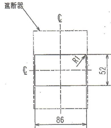
穴明寸法は遮断器窓枠に対し片側1.0の隙間をもたせたいです。
